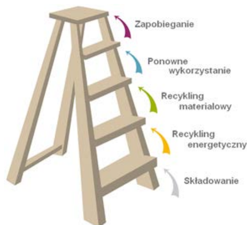
Rys. 1. Hierarchia postępowania z odpadami przyjęta przez UE w ramach ramowej dyrektywy w sprawie odpadów (CEWEP 2009)
